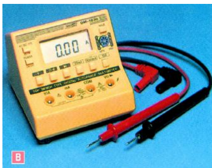
شكل (١١) جهاز رقمي يقيس كلاً من (A, V, R)
